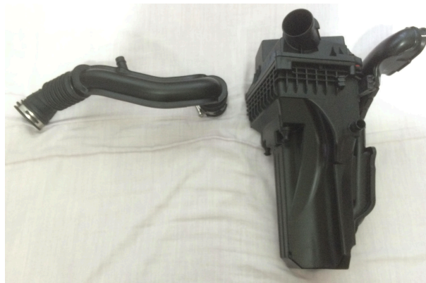
Figura 3.2: Foto do coletor de admissão cedido pela Ford.
