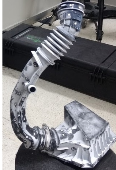
Figura 3.7: Componente sanfonado posicionado para escaneamento à laser.
