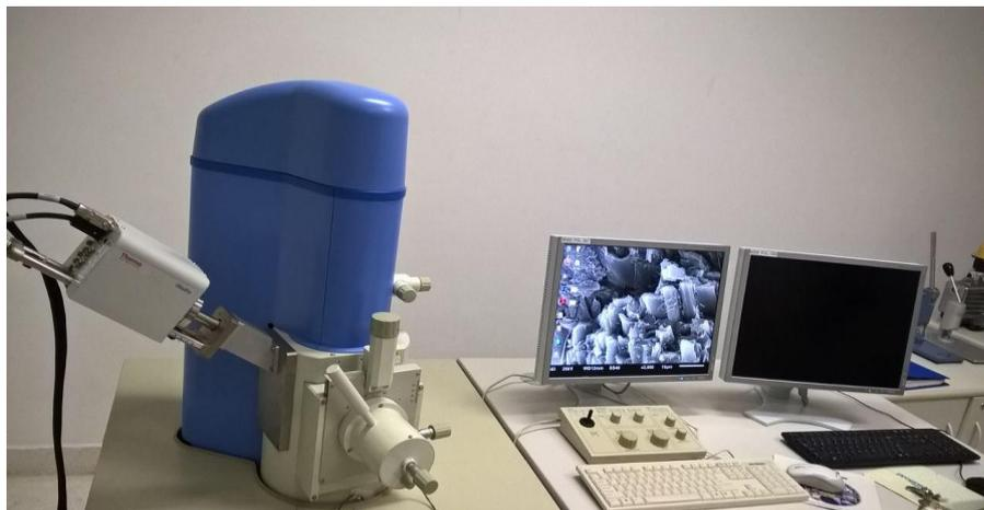
As amostras de fibra de casca de coco foram submetidas à análise no microscópio eletrônico (Zeiss Scope A1 com aplicação máxima de 1000 vezes, equipado com câmera Zeiss Axiocam ERc5s) antes e após a deslignificação para se obter uma visualização das alterações causadas pelo agente oxidante (peróxido de hidrogênio) na matriz lignocelulósica.
