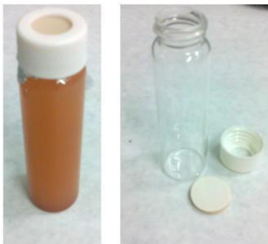
**Figura 14 - Recipiente utilizado para reação de adsorção.**
