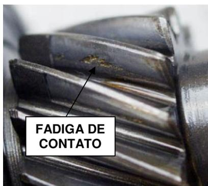
Figura 12 – Falha por fadiga de contato.
