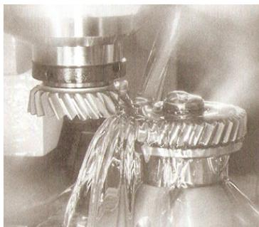
Figura 6 – Usinagem do dentado de engrenagem de dentes helicoidais (JUVINALL; MARSHEK, 2000).
