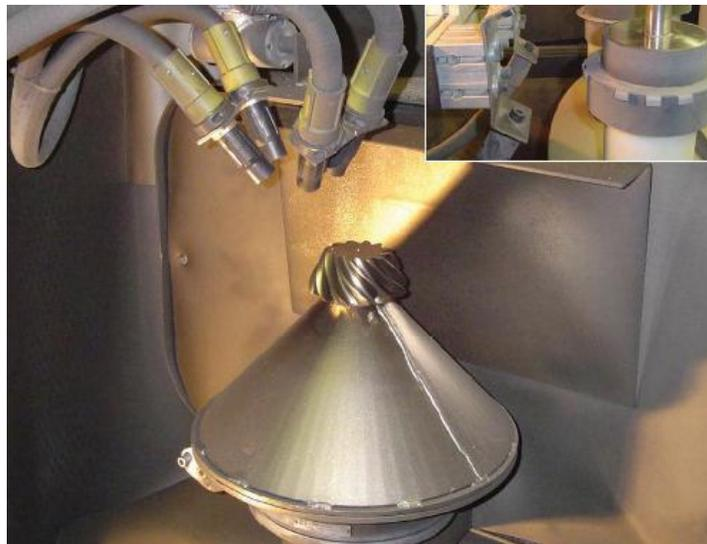
Figura 40 – Engrenagem posicionada para o processo de *shot peening* pneumático.
