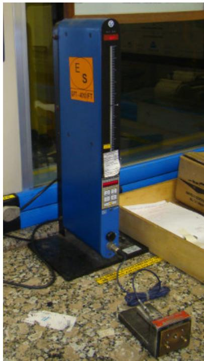
Figura 75 – Dispositivo de medição da intensidade *Almen*.
