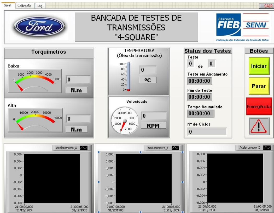
Figura 106 – Interface do supervisor de controle da bancada.
