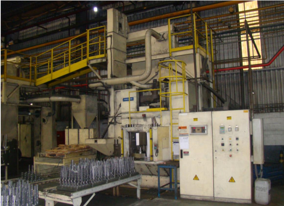
Figura 74 – Máquina utilizada para o jateamento dos corpos de prova.
