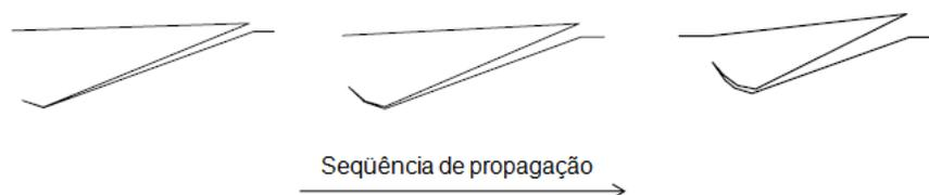
Figura 20 – Seqüência de propagação da trinca de *pitting* (ZAFOSHNIK et al, 2007).
