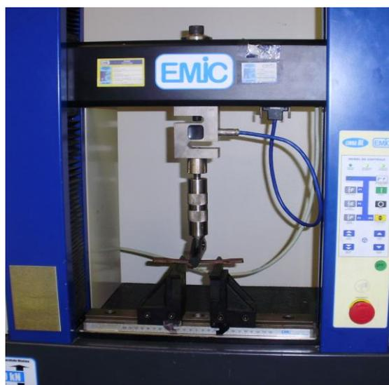
Figura 5A: Máquina EMIC para ensaios de resistência a Tração e Flexão.
