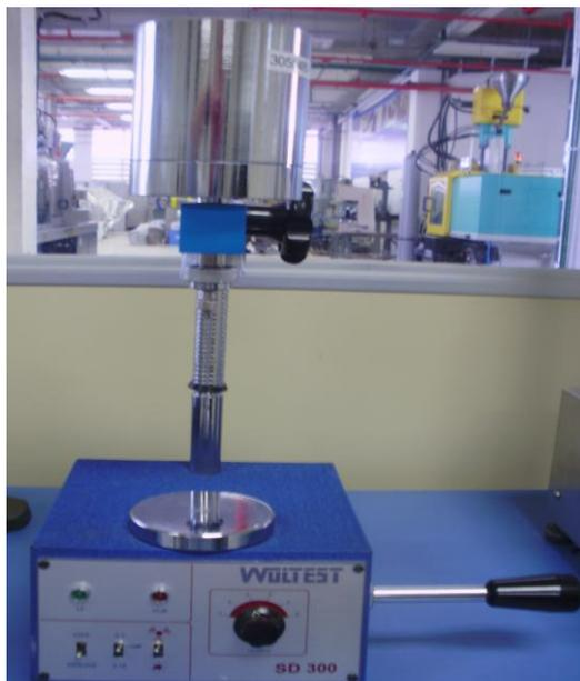
Figura 7A: Equipamento WULTESTE SD300 para ensaios de dureza shore D.
