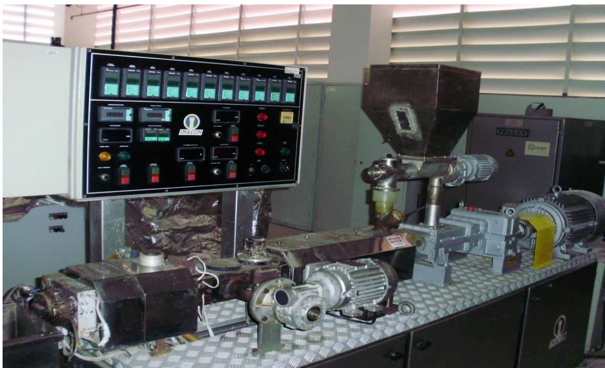
Figura 3A: Extrusora dupla rosca, co-rotativa, fabricada pela IMACON
