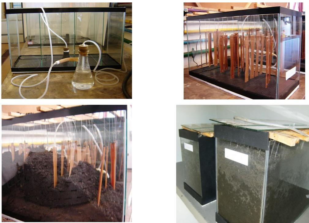
Figura 3.1: Ensaio de biodegradação (testes sturm)
