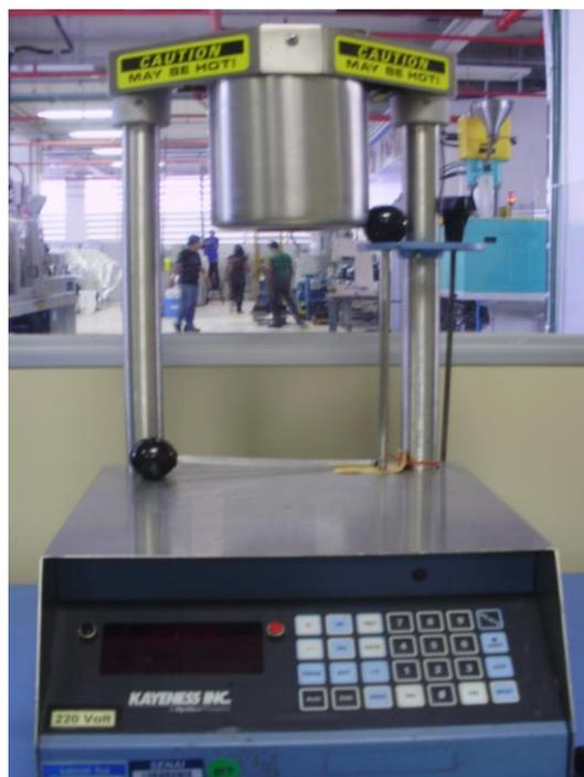
Figura 2A: Vista frontal da máquina para ensaios de MFI
