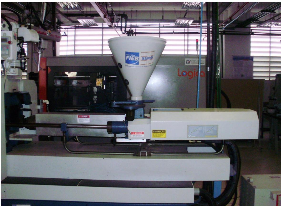
Figura 4A: Vista da Injetora de polímeros PRIMAX 100R, fabricada pela ROMI.
