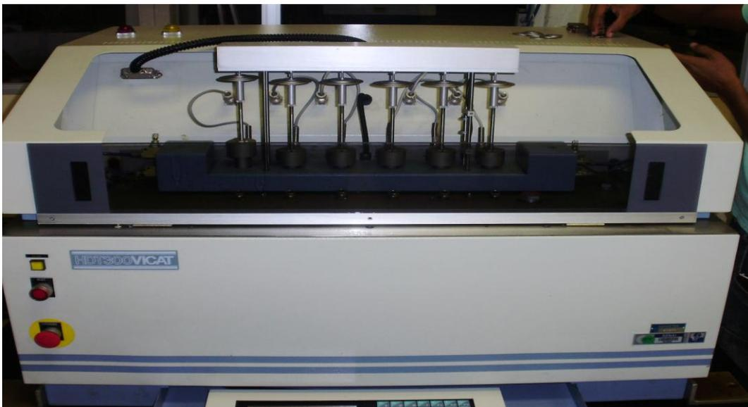
Figura 1A: Vista frontal da máquina para ensaios VICAT e HDT
