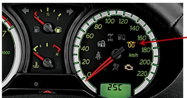
Figura 22 - Sinal luminoso - Indicador do Aquecimento do SPF Eletrônico Proposto
