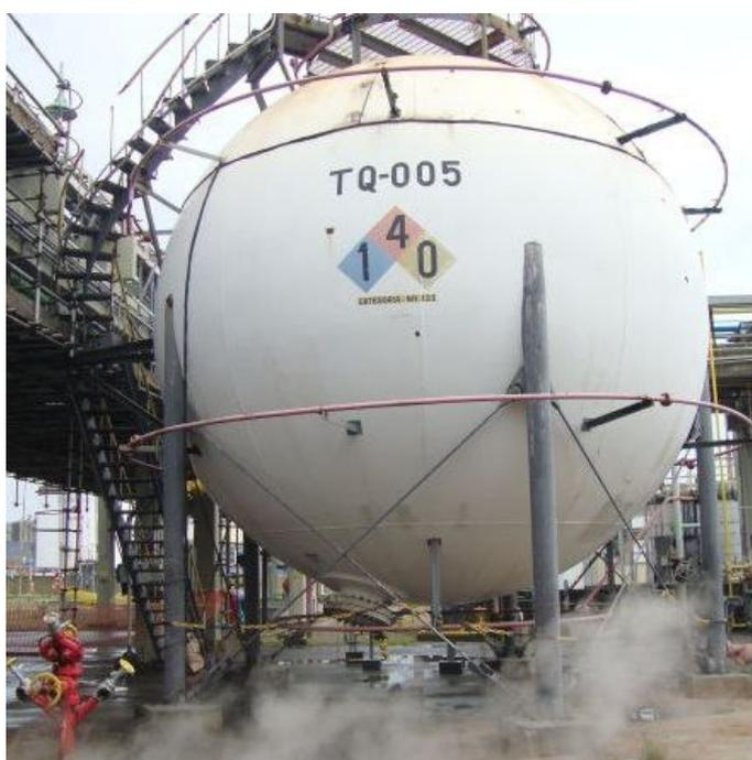
**Figura 3 – Vaso de pressão esférico**
