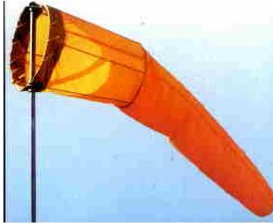
Figura 2.16 Biruta, equipamento utilizado para determinar a direção do vento. Fonte: www.americanas.com.br
