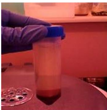
Figura 3 - Massa de lignina após centrifugação.
