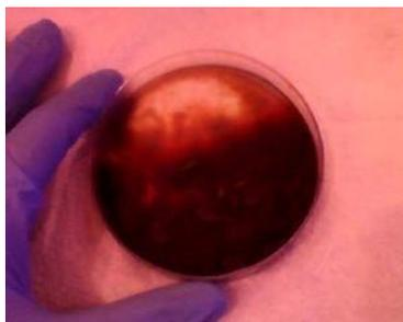
Figuras 4 - Torta de Lignina após 1h na estufa a 40°C
