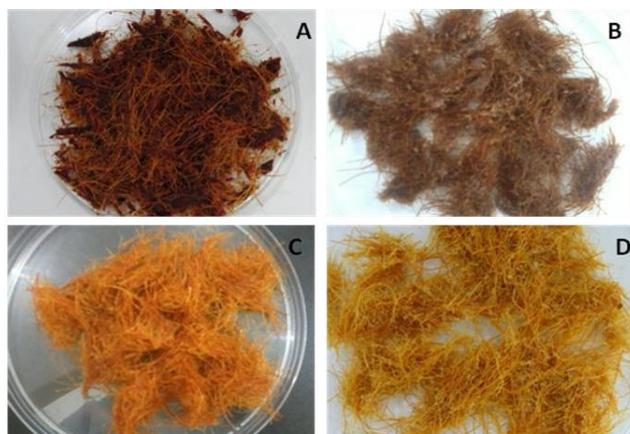
**Figura 4.** Obtenção das fibras após lavagem com solução de NaOH a 2%. Em (A): fibra após primeira lavagem, (B): fibra após segunda lavagem, (C): fibra após terceira lavagem e (D) fibra após quarta lavagem.
