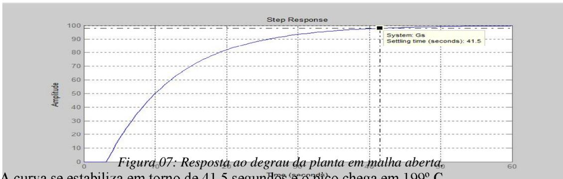
Figura 07: Resposta ao degrau da planta em malha aberta, a curva se estabiliza em torno de 41,5 segundos e o pico chega em 199° C.
