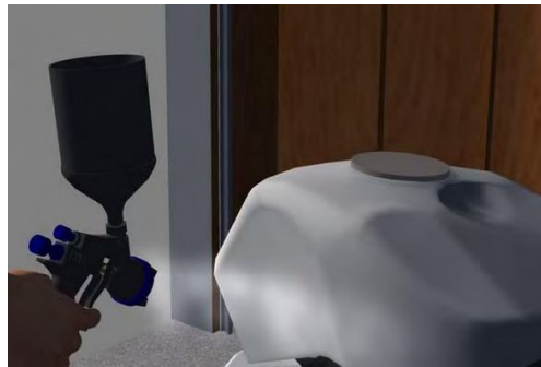
Figura 6 – Pintura de Tanque de Combustível Metálico
