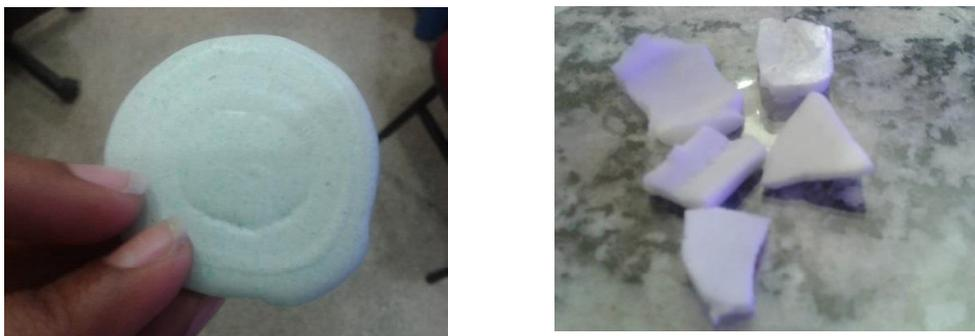
**Figura 3.** Polímero proveniente do PET com pigmento verde (a esquerda) e proveniente do ácido tereftálico comercial puro (a direita).
