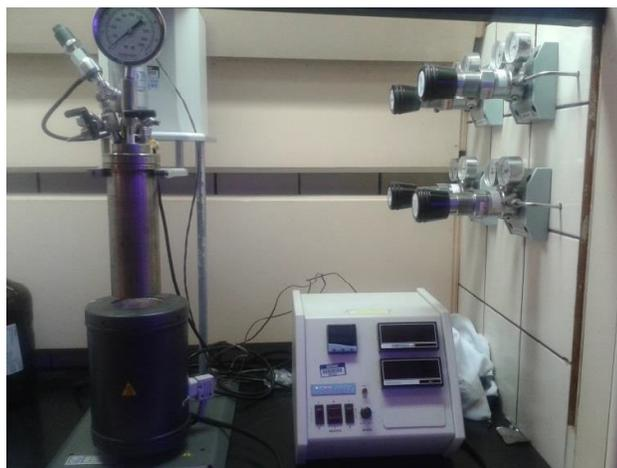
Figura 4. Reator pressurizado.
