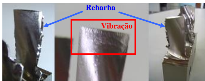
Figura 13. Rebarba e marcas de vibração deixadas nas pás.
