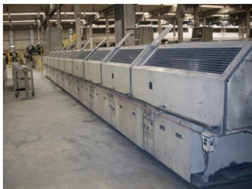
Figura 3. Máquina de trefilar utilizada no experimento.
