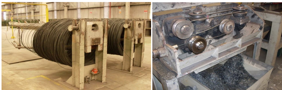
Figura 1. Suportes desbobinadores de bobinas de fio-máquina (à esquerda) e decapador mecânico por flexão (à direita).
