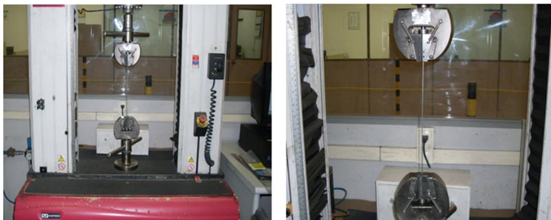
Figura 5. Máquina de ensaio universal utilizada para os testes de tração.
