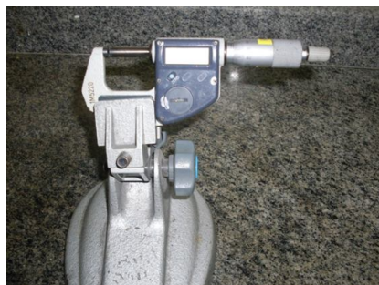
Figura 4. Micrômetro utilizado na análise dimensional dos fios trefilados.
