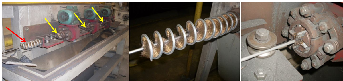
Figura 2. Bancada de escovas e sopradores, escova espiralada e escova rotativa.
