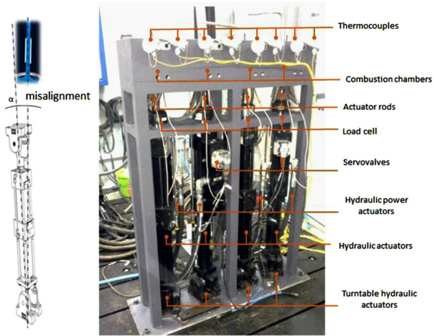
Fig. 3. Wear test apparatus.
