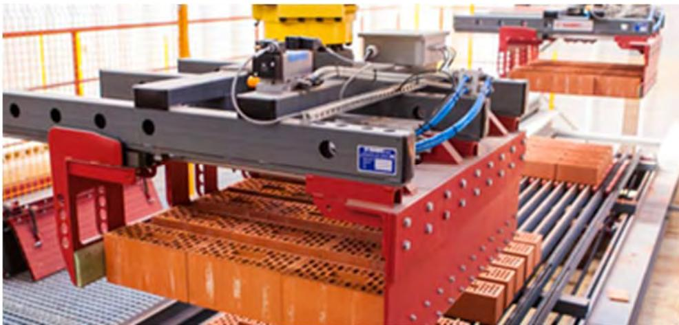
**Figura 2.** Esteira transportadora e ferramenta de manipulação tipo garra.
