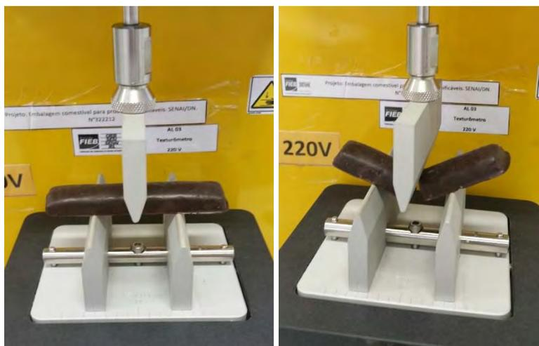
Figura 2. Ilustração da barra de *líquor* submetida à análise de textura.
