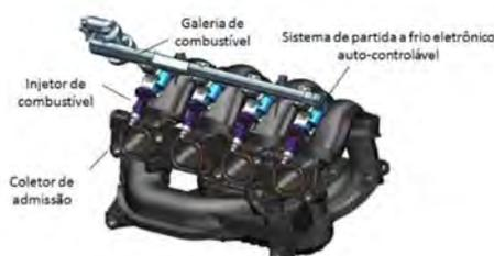
*Figura 3 – Ilustração do Sistema de Partida a Frio Eletrônico Auto-Controlável montado em Aplicação Veicular [12].*
