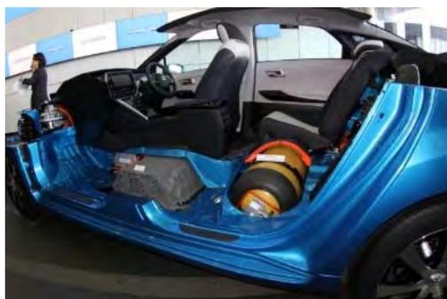
Figura 10. Tanque de hidrogênio sob o banco traseiro. [5]
