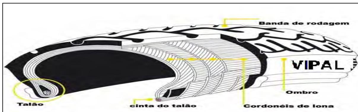
Figura 02: Estrutura de um pneu de motocicleta
