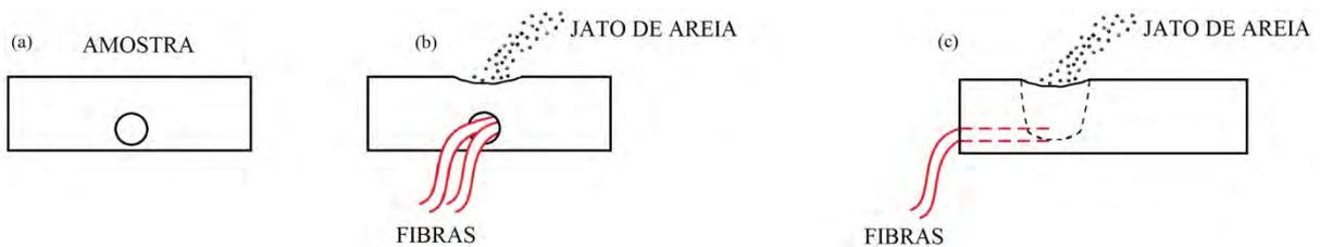
**Figura 13– Vista da amostra (a) frontal (b) com as fibras inseridas (c) em corte**
