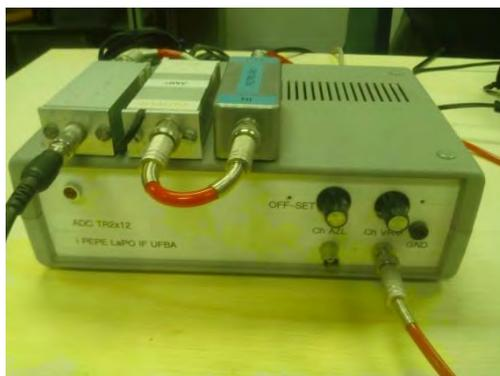
**Figura 5. Interface de aquisição de dados com fotodetector,**
