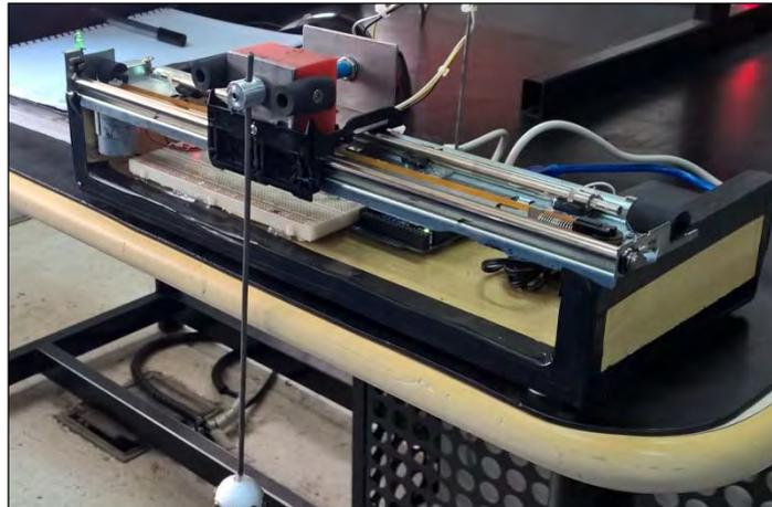
Figura 3 – Haste posicionada para aplicação do método do limiar de oscilação. (Fonte: Autor)
