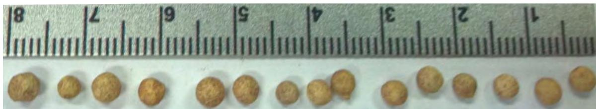
Figura 1. Amostras de partículas do catalisador que forma o meio poroso comparativamente a uma escala graduada em centímetros. (Fonte: elaborada pelo próprio autor).
