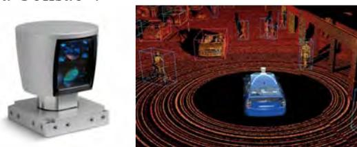
*Figura 9 - Velodyne HDL-64E e utilização para escaneamento do ambiente<sup>[17][18]</sup>*
