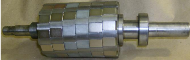
Figura 3 – Rotor protótipo com ímãs inclinação intermediária - 5°
