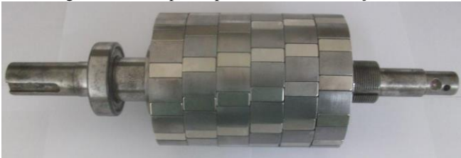
Figura 4 – Rotor protótipo com maior inclinação - 7°
