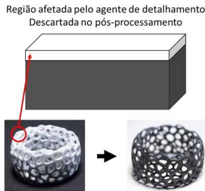
Figura 152. Representação da região afetada pelo agente de detalhamento no processo MJF, que é descartada durante o pós-processamento.
