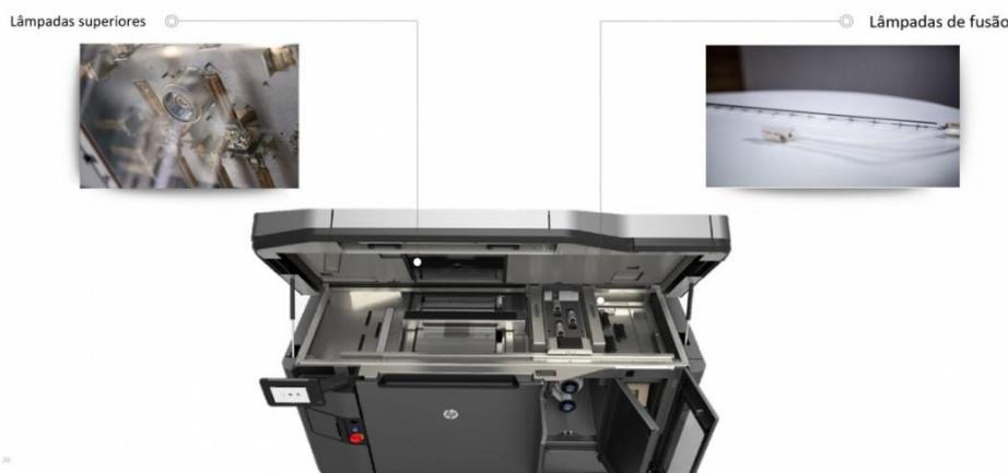
Figura 32. Lâmpadas térmicas superiores e lâmpadas de fusão em uma impressora 3D HP Jet Fusion 4200 (MOURA, 2021).
