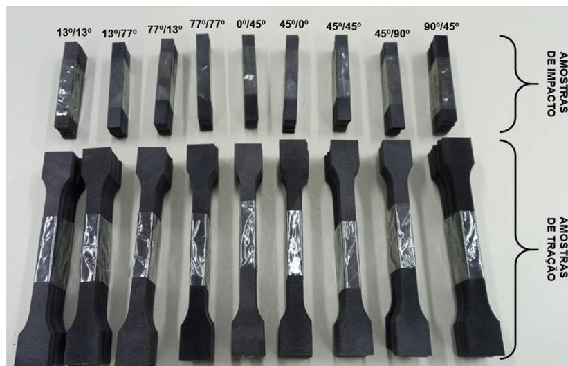
Figura 67. Amostras do trabalho de avaliação da orientação de impressão, separadas após o desempacotamento e jateamento.
