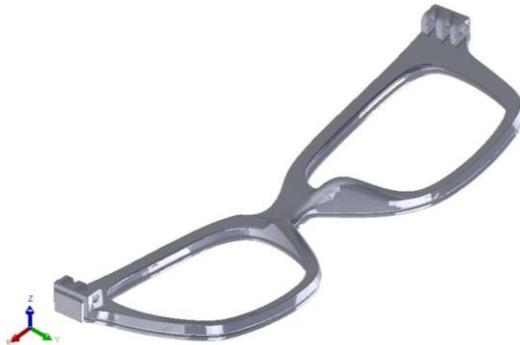
Figura 71. Modelo 3D de peça selecionada para análises, sendo uma peça frontal de armação de óculos manufaturados aditivamente.
