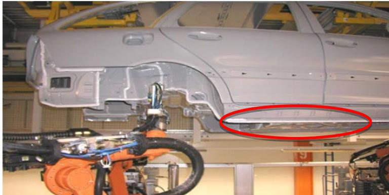
Fonte: Utilização do robô na aplicação de selagem. Adaptado pelo autor (2019)
