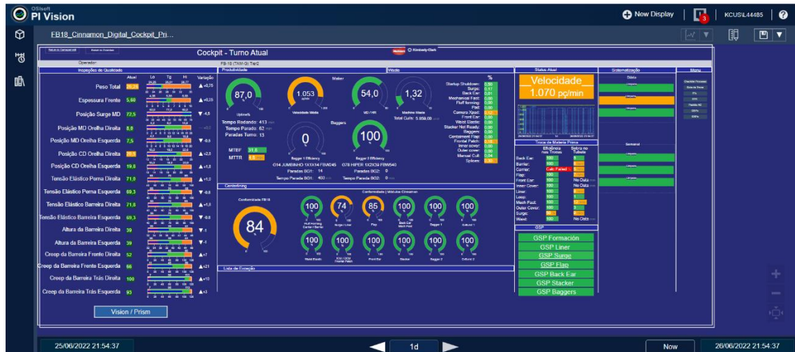
Figura 7 – Tela sinótica com informações do processo de uma máquina de fralda (Fonte: Elaborado pelo Autor)
