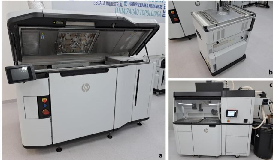
Após o processo de impressão os CPs ficaram dentro da unidade de desenvolvimento em resfriamento lento de aproximadamente 23h, sendo posteriormente a unidade de desenvolvimento acoplada à unidade de processamento para descompactação das amostras. Por fim, estas foram levadas para limpeza em uma câmara onde passou por jateamento com microesferas de vidro. O esquema do processo de impressão pode ser observado na Figura 16.
