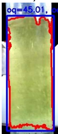
Figura 3. Determinação do final da extração 16 pelo processamento de imagem
