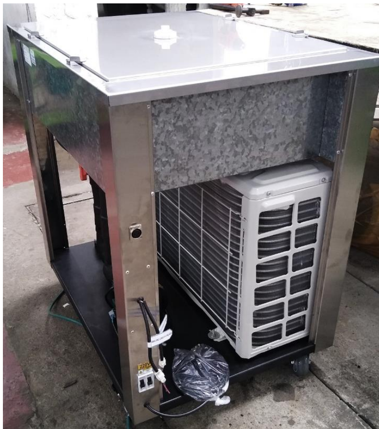
Figura 23. Unidade de água gelada ( chiller ).
