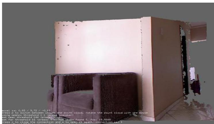
A figura 2 apresenta a tela principal da aplicação, que permite observar diversas informações. O sistema de mapeamento 3D dispõe de aplicações, como a geração e visualização em RGB, Binarizada e IR, o cálculo de profundidade da imagem. Na figura 3 observa-se a geração do mapa tridimensional (nuvem de pontos) e o registro e armazenamento de imagens de profundidade.
