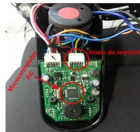
Fig. 8. Sistema de acionamento da cadeira de rodas.
