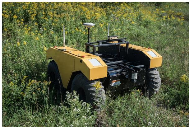
Figura 2.7: Warthog, robô terrestre anfíbio.
