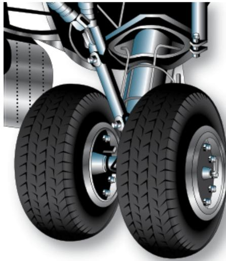
Figura 1.2: Trem principal duplo de um trem de pouso do tipo triciclo.
