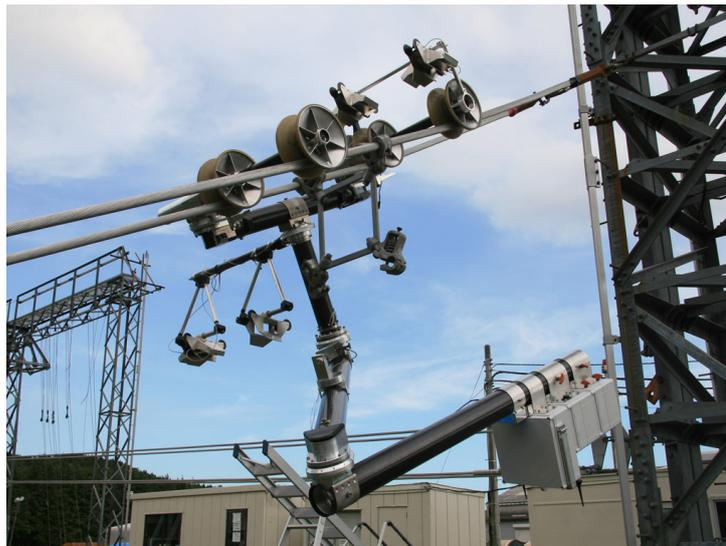
Figura 1.3: Expliner: Robô para inspeção de linhas de transmissão.
