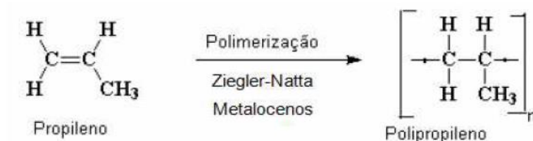
Figura 1: Representação esquemática da reação de polimerização do PP
