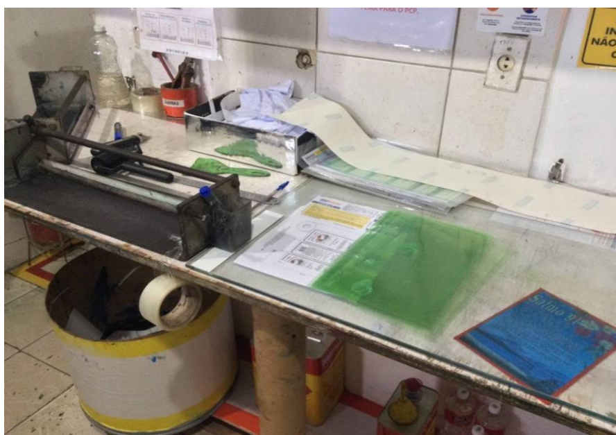
Figura 13 –Clichê em processo de montagem.
