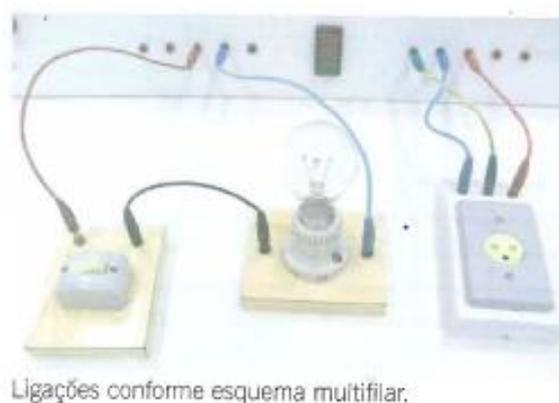
Figura 4: Exemplo de esquema multifilar na prática.
