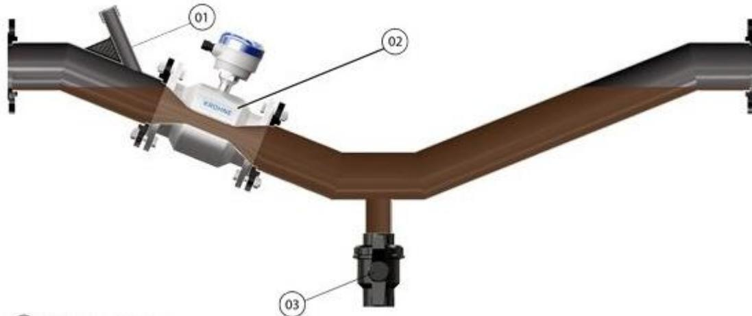
Figura 4: Princípio de funcionamento da solução .
