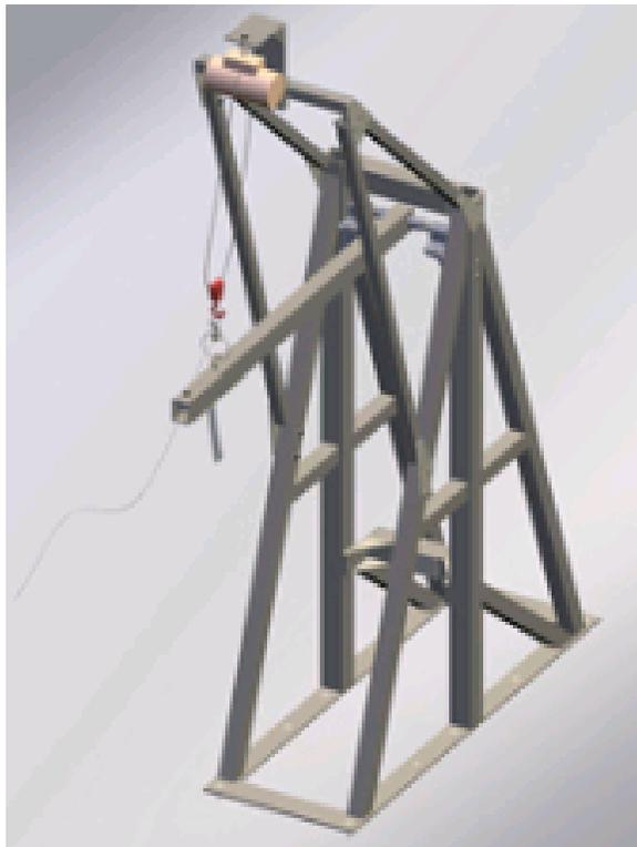
Figura 61 – Equipamento de Teste do Pendulo (HUMANETICS, 2011d)
