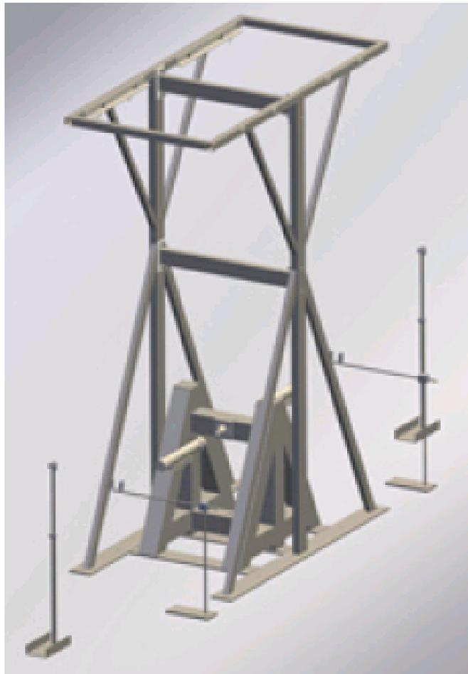
Figura 63. – Equipamento para Realização do Teste de Impacto no Joelho do Manequim de Teste (HUMANETICS, 2011f)
