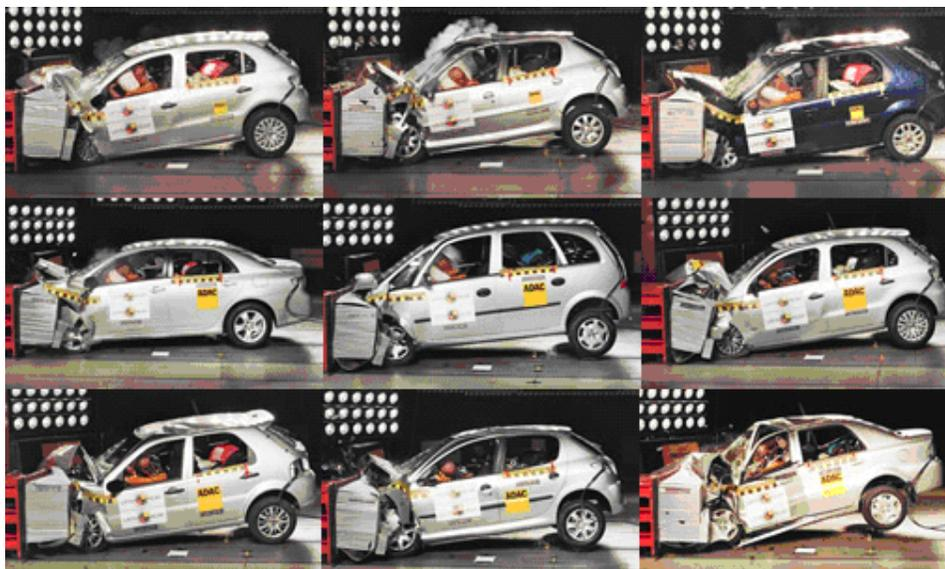
Figura 58 – Fotos do momento dos impactos dos primeiros testes de impacto frontal do *Latin NCAP*, sendo, da esquerda para direita, na primeira linha, Gol com *Air Bag*, 207 com *Air Bag* e Pálio com *Air Bag*. Na segunda linha, Corolla, Meriva e Gol sem *Air Bag*. Na terceira linha, Pálio sem *Air Bag*, 207 sem *Air Bag* e CK1 (*Latin NCAP*, 2010d).
