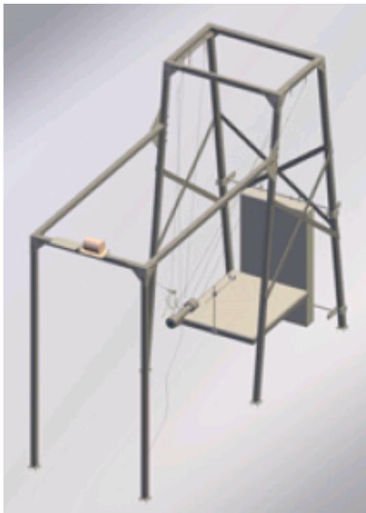
Figura 62 – Equipamento para Realização do Teste de Impacto no Peito do Manequim de Teste (HUMANETICS, 2011e)
