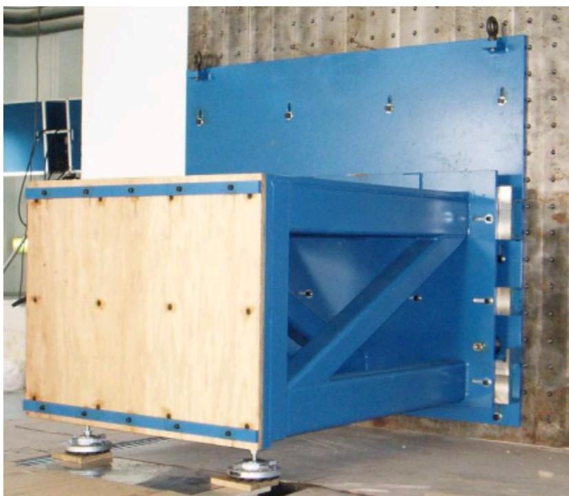
Figura 68 – Estrutura de Fixação da Barreira de Impacto Deformável, da Calspan®
