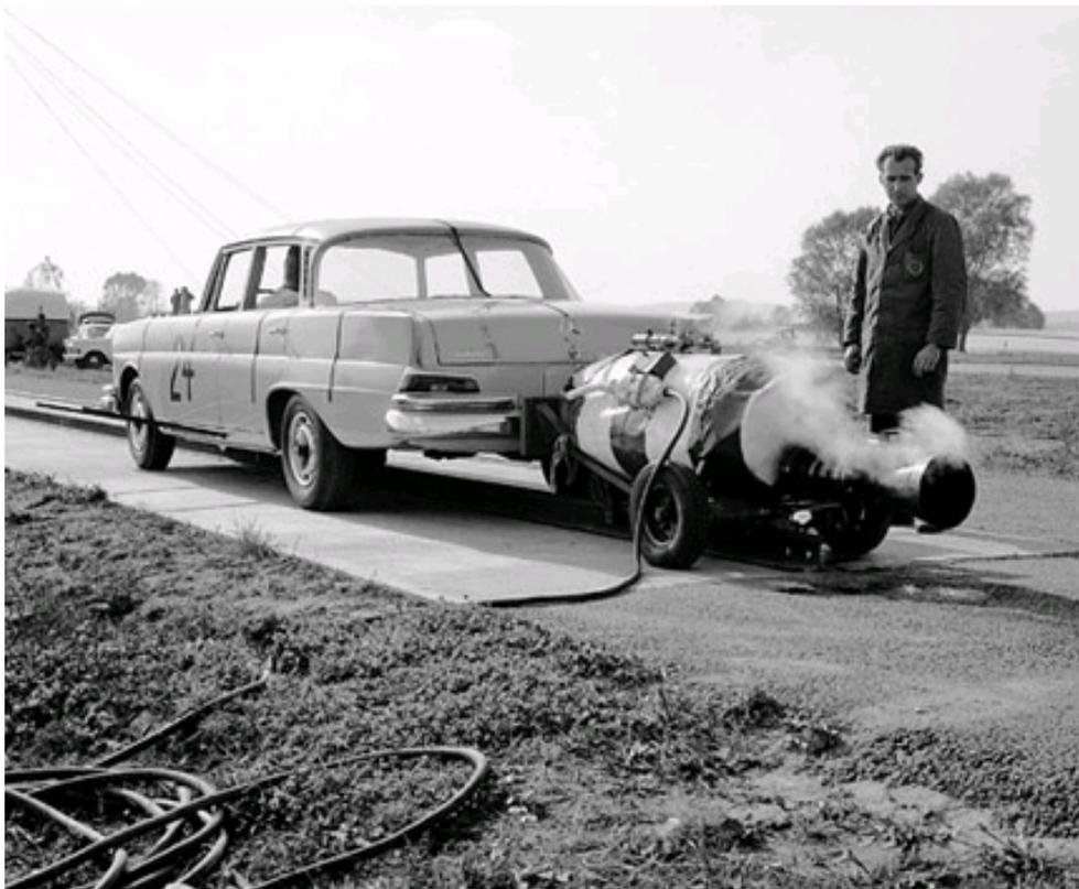
Figura 6 – Foguete de Impulsão da Mercedes-Benz (MotorwayAmerica, 2011).
