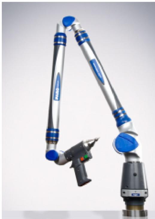
Figura 71 – Sistema de Medição de Coordenadas (Faro®, 2011)
