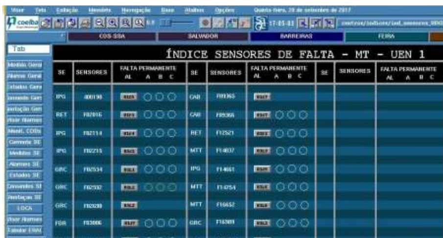
Figura 3 Tela do SCADA para os conjuntos de Sensores. FONTE: COELBA
