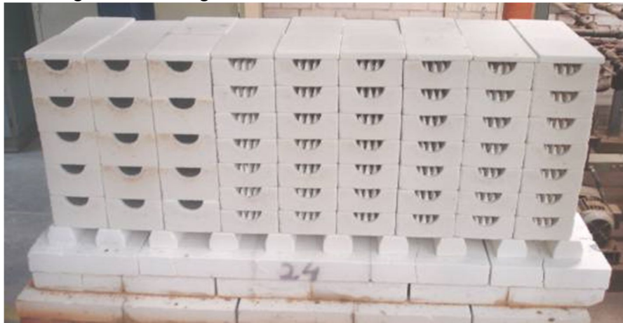
Figura 17 – Vagoneta com isoladores acondicionados
