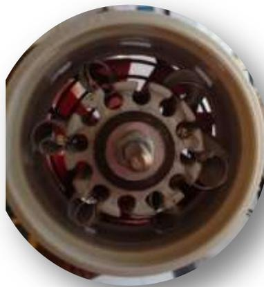
*Figura 4. Elemento aquecedor montado no suporte cerâmico.*
