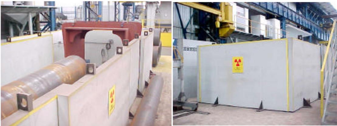
*Figura 4. Instalação Radiográfica Aberta, para inspeção de tubos com Ir-192 e Raios X, com até 10 m de comprimento. As paredes de 25 cm de concreto baritado, são móveis, podendo ser montados em qualquer área da fábrica. (ANDREUCCI, 2003)*
