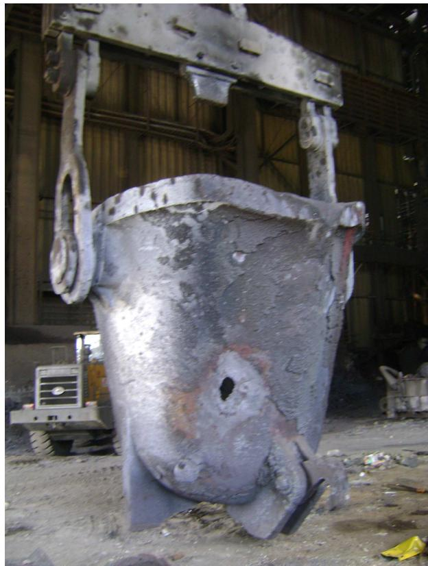
Panela de transferência danificada, devido as condições operacionais.
