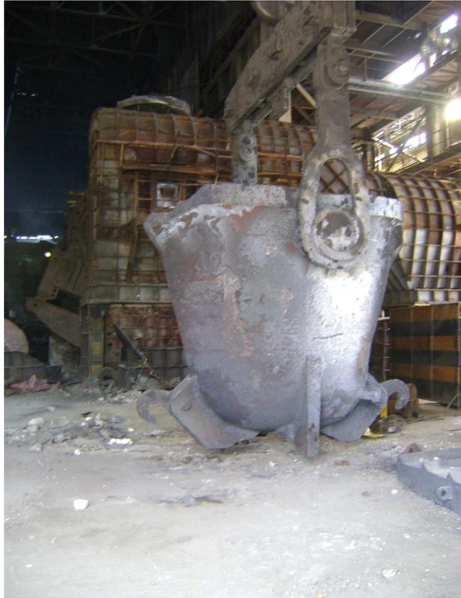
Panela de transferência, sendo acionada pela ponte rolante próximo aos conversores.
