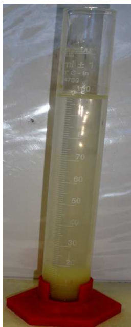
Figura 3-4 - Teste de inchamento Foster em argila sódica
