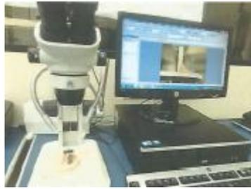
Figura 4: Equipamento necessário para o teste de macrografia.
