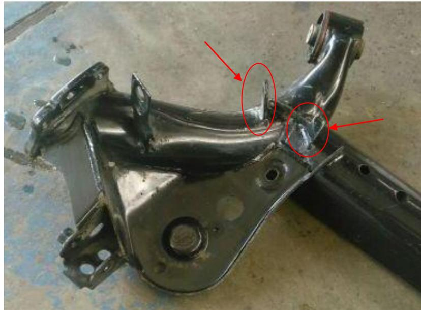
Figura 9: Exemplo do posicionamento dos cordões CC em eixo semelhante.
