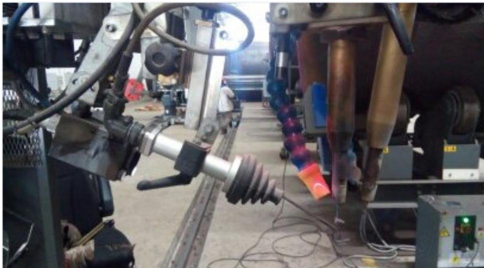
Figura 1 Processo de Arco Submerso (SAW) Tandem
