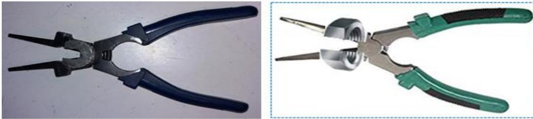
Figura 3: Dispositivo de verificação do comprimento do stick-out.
