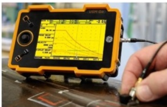
Figura 12 - Inspeção com Ultrassom. Fonte: GE Company (2010)
