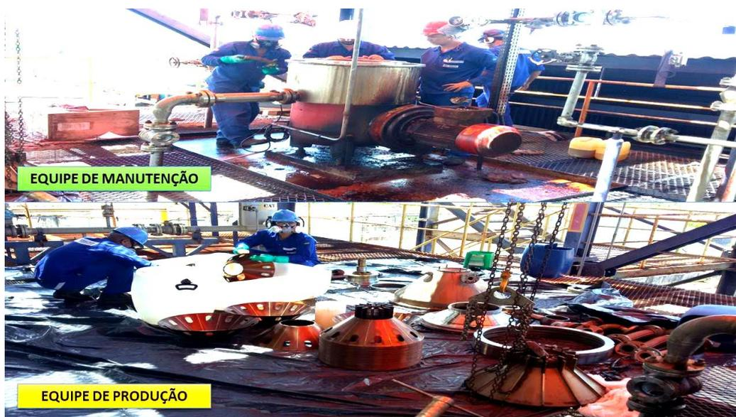
**Figura 05 – Apoio da Equipe de Produção na manutenção da Centrifuga**
