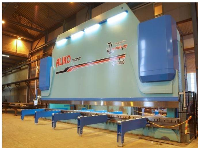
**Figura 13 – Prensa Aliko. Modelo: Giant SP 14000-2200 CNC.**
