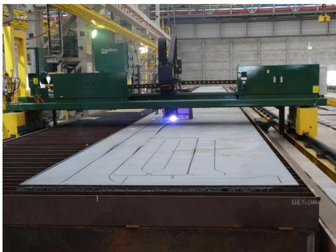
**Figura 11 – Máquina de Corte CNC à Plasma.**
