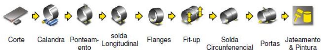
**Figura 5 – Processos para fabricação de uma torre eólica.**
