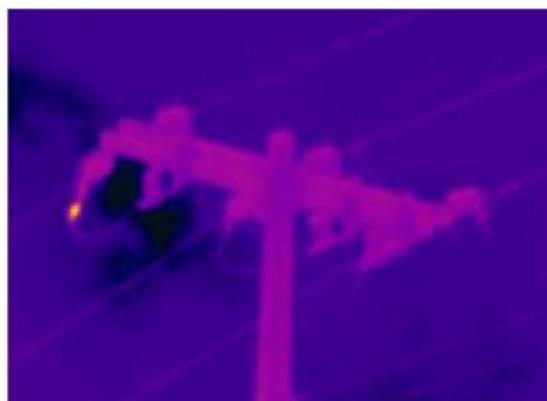
**Figura 4.12 Ponto quente na conexão da chave face**
