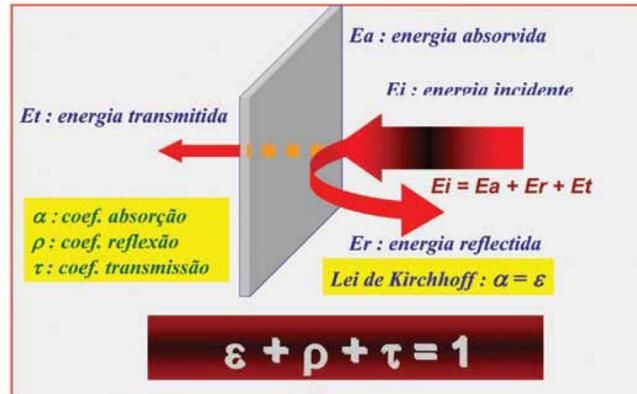
Figura 2.3 - Relação entre energia absorvida, transmitida e refletida.
