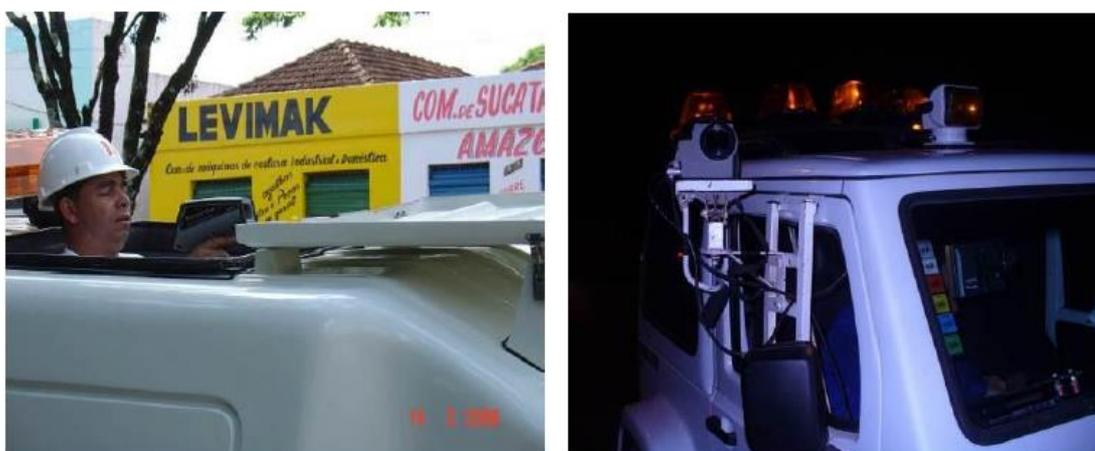
**Figura 3.6 – Inspeção de redes de distribuição com termovisor**
