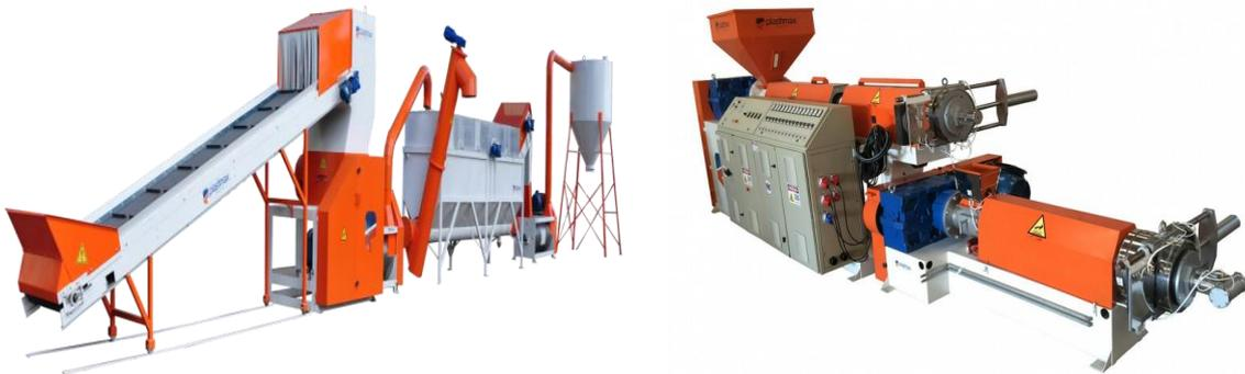
Figura 2: Equipamentos de moagem e extrusão de PEAD.
