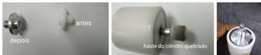
Figura 6 – Mudança no cilindro pneumático do freio do mandril
