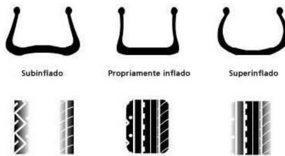
Figura 21 – Configurações de calibração de pneu. retirado do <http://www.howstuffworks.com> em 02/03/11
