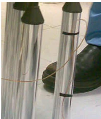
**Figura 7 – Detalhe da fixação externa dos sensores feita com fita isolante**
