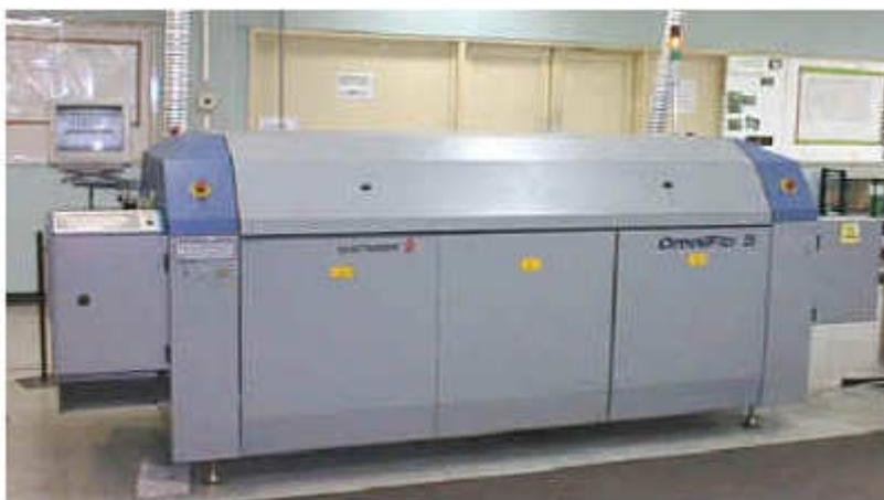
**Figura 19– Forno de refusão por convecção forçada**
