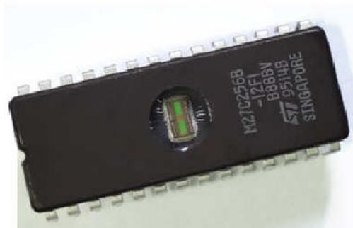
**Figura 21– EPROM – Espaço para penetração da radiação UV**
