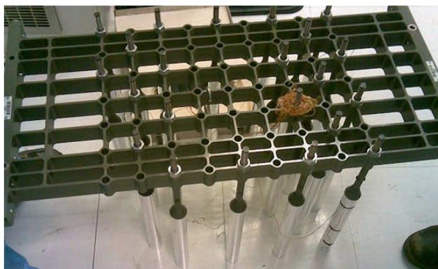
**Figura 5- Dispositivo utilizado para medir a temperatura atualmente – "Mole"**
