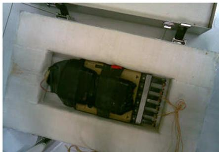
**Figura 6 - Datalogger – Dispositivo de armazenamento dos dados coletados pelos sensores dentro de uma caixa refratária**
