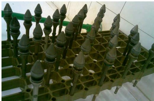
**Figura 2 - Carrier com os 32 chucks (Transportador e fixadores dos OPC's durante a seção B)**
