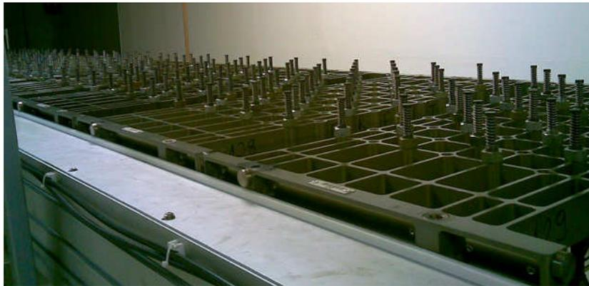
**Figura 4 - Fila de retorno dos transportadores ao início do processo**
