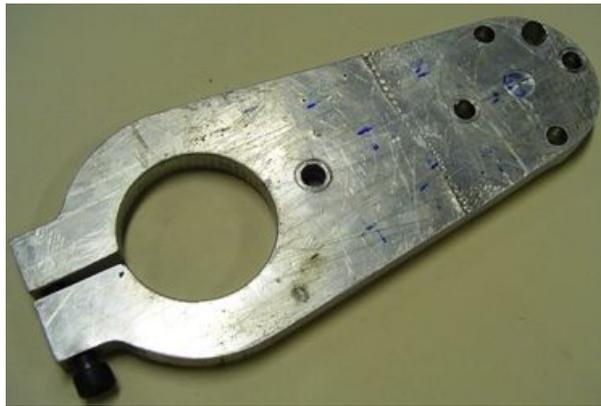
**Figura 8** – Suporte da Retificadora/Robô.
