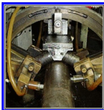
Figura 4 – Ensaio por ultrassom em uma tubulação. Extraído de **tubonal**, 2009.
