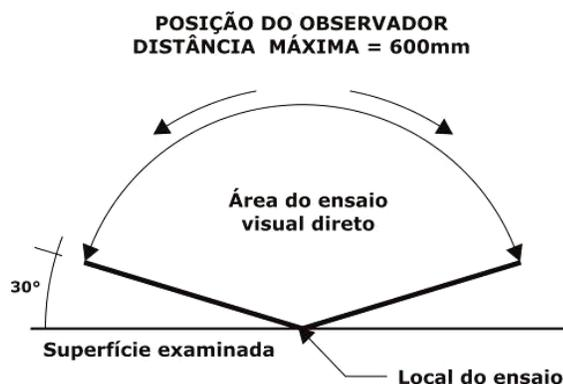
Figura 1 – Esquema ilustrando a posição do inspetor na realização do ensaio visual direto.
