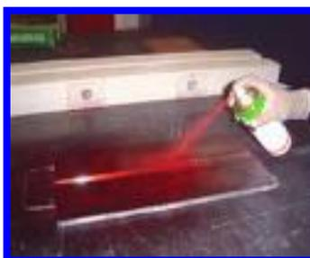
Figura 7 – Aplicação do LP na superfície examinada. Extraído de SENAI.FIEB, 2009.
