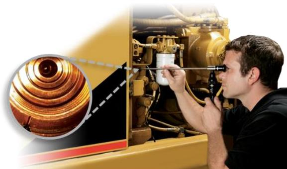
Figura 2 – Ensaio visual remoto utilizando o boroscópio. Extraído de ABENDE, 2004.
