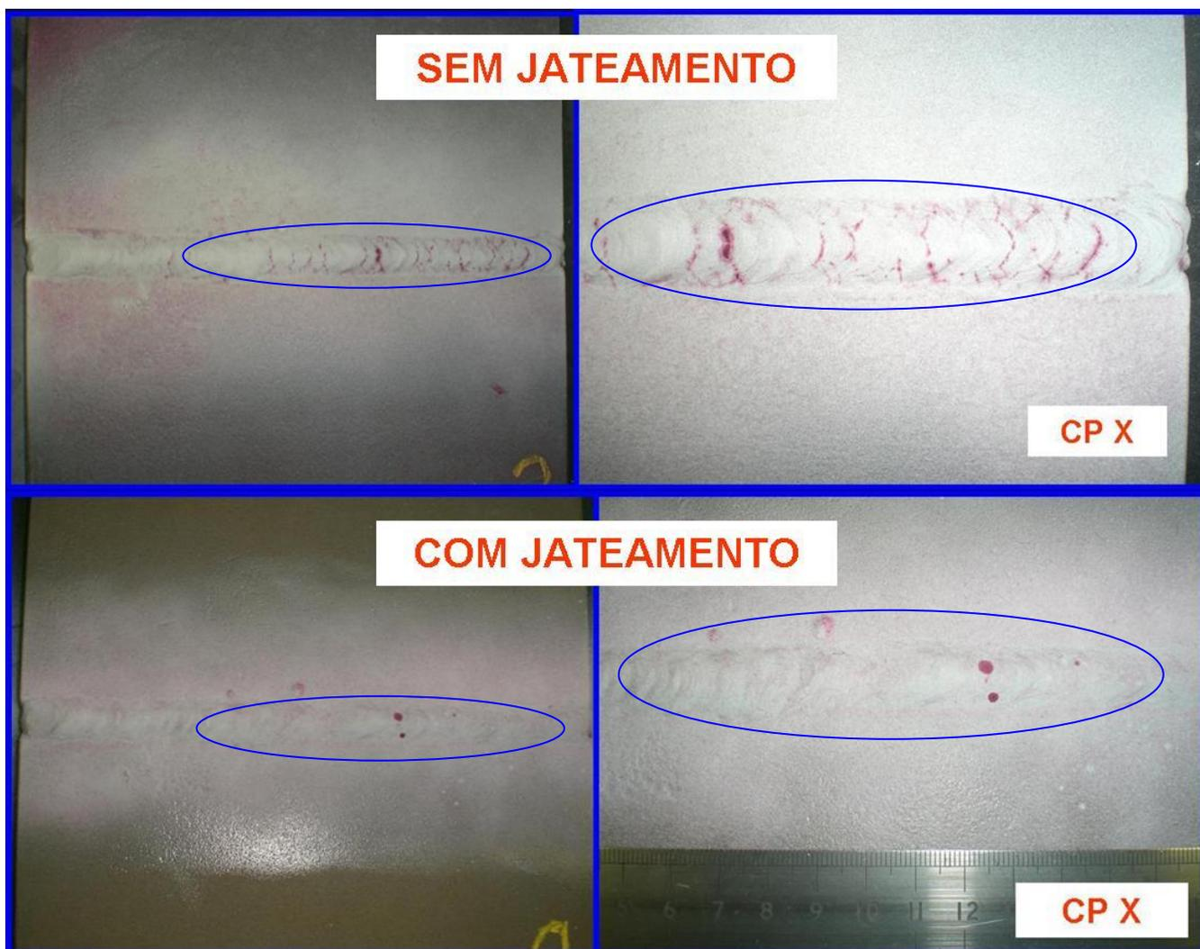
Figura 32 – Comparação dos resultados obtidos nos ensaios realizados no CP X sem jateamento e depois de jateado e escovado – LP tipo II.
