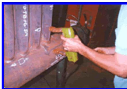
Figura 3 – Ensaio através de partícula magnética. Extraído de emmapro, 2009.
